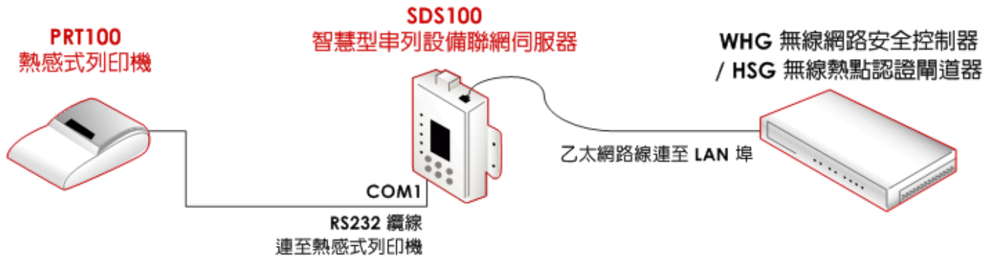
SDS100 連接前端 PRT100 和後端 WHG 控制器示意圖
